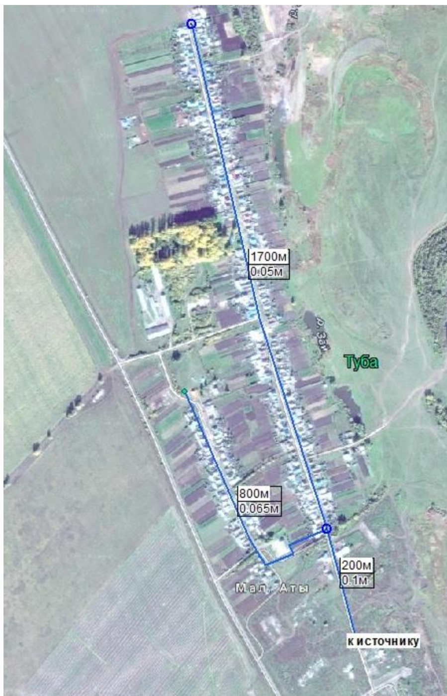
Рисунок 1-7. Зона централизованного водоснабжения н.п. Туба
