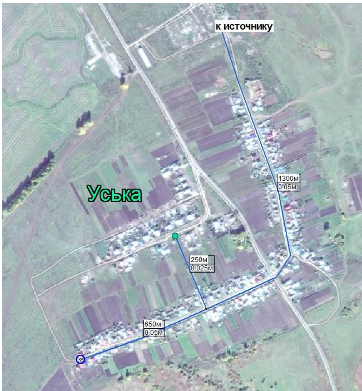
Рисунок 1-8. Зона централизованного водоснабжения н.п. Уська
